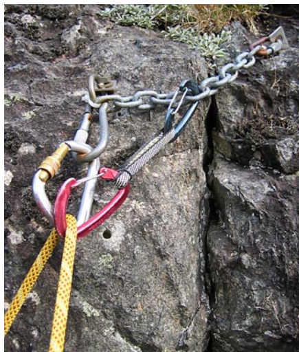
Anker rigget for topptauklatring
